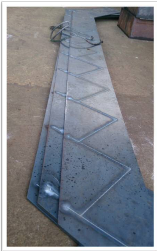
・ササラ 2100x6096の板で切断します。 パウダーマーキングで、段板・根太の ケガキをいれています。
